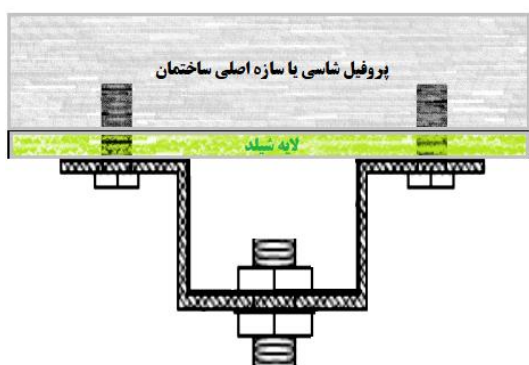
شکل ۲-۲: نمونه دستک های U شکل جهت اتصال تجهیزات به سقف
