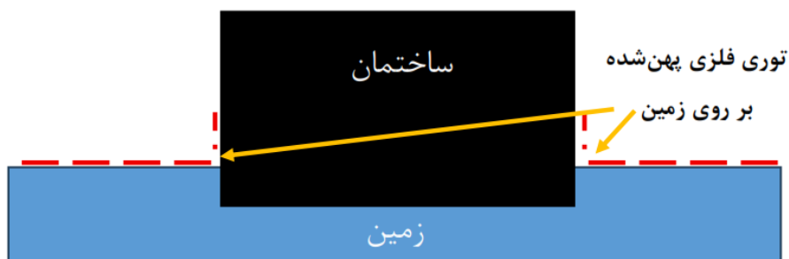
شکل ۴-۱: نصب توری فلزی بر روی زمین در اطراف ساختمان
